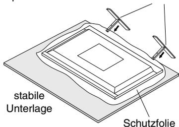
**HINWEIS:** Montieren Sie den Fuß in Richtung der auf der Oberfläche des Fußes eingepprägten Pfeilmarkierung. Verwenden Sie das Modell ST-801 für den V801.
