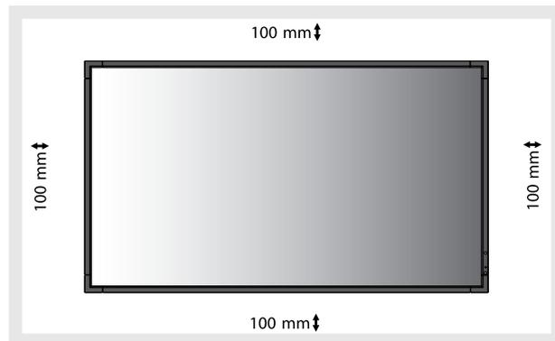
Achten Sie auf ausreichende Luftzufuhr oder sorgen Sie für Klimatisierung am Monitor und an der Montagevorrichtung, damit die entstehende Wärme abgeführt werden kann, insbesondere, wenn Sie mehrere Monitore nebeneinander verwenden.
