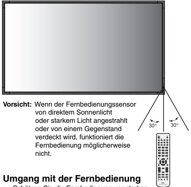
**Vorsicht:** Wenn der Fernbedienungssensor von direktem Sonnenlicht oder starkem Licht angestrahlt oder von einem Gegenstand verdeckt wird, funktioniert die Fernbedienung möglicherweise nicht.
