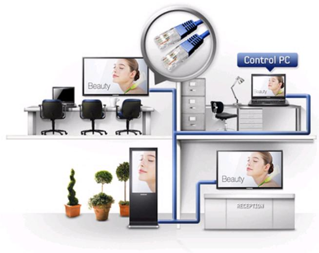
Gerade bei umfangreicheren Display-Installationen, z.B. in Firmengebäuden über verschiedene Etagen verteilt, ist eine zentrale und einfache Fernwartung von großer Bedeutung. Dieses Samsung Large Format Display unterstützt die Fernsteuerung und Überwachung per konventioneller RS-232C-Schnittstelle, aber auch per RJ-45-Anschluss, was besonders bei größeren Distanzen zwischen Kontroll-PC und zu überwachenden Displays von Vorteil ist.
