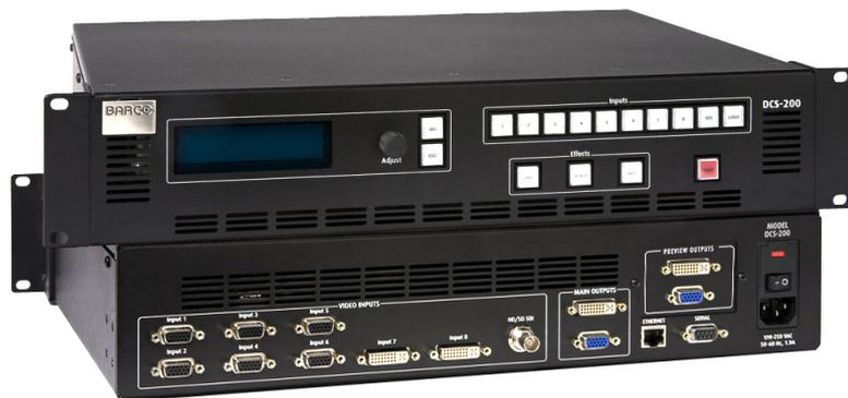
Der DCS-200 ist ein 2-Kanal-Switcher, der zu einem wirtschaftlichen Preis ermöglicht, bei gleichzeitiger Aufrechterhaltung einer überragenden Bildskalierungsqualität wirklich übergangslos zwischen mehreren Eingangsquellen und Formaten umzuschalten. Er wurde für den unkomplizierten und einfachen Betrieb konzipiert. Daher ist er der ideale Seamless-Switcher für Live-Events, Sitzungssäle, Festsäle, Gotteshäuser, Hörsäle, Trainingseinrichtungen und mehr.
