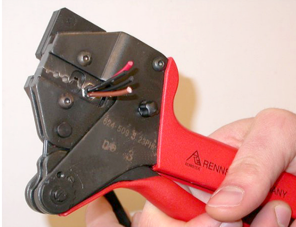
Bild 6.72: Crimpen der Hülse
