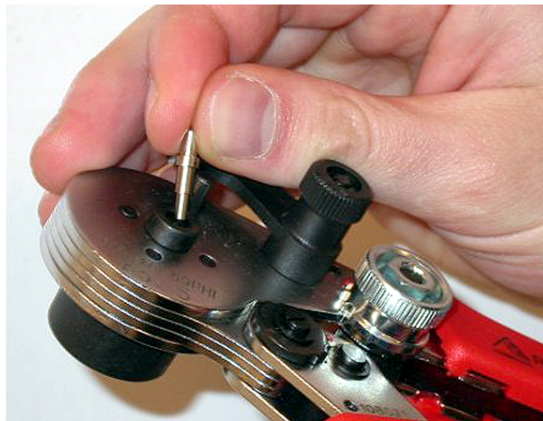
Bild 6.84: Einsetzen einer Ferrule
