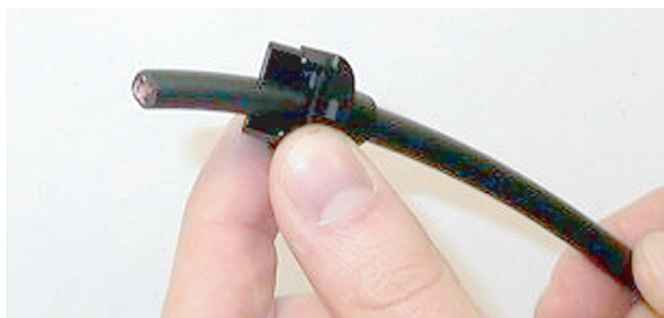
Bild 6.69: Hinteres Gehäuseteil auf Kabel
