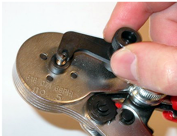
Bild 6.85: Arretieren einer Ferrule
