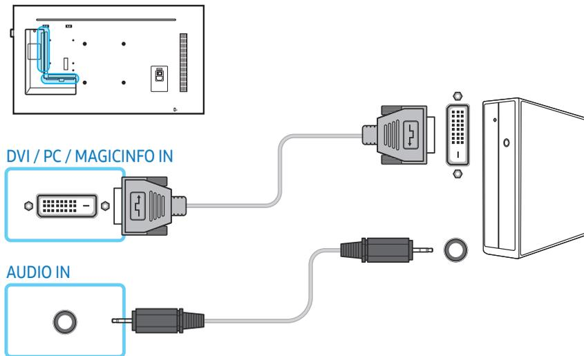
Sie können den DVI-Anschluss am Gerät mit einem DVI/HDMI-Adapter als HDMI-Anschluss verwenden.
