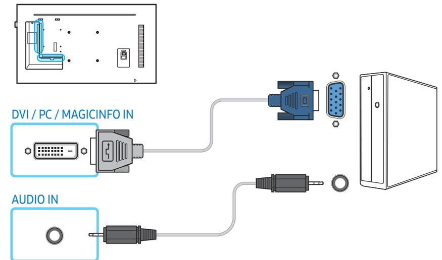
Sie können den DVI-Anschluss am Gerät mit einen D-SUB/DVI-Adapter als D-SUB-Anschluss verwenden.
