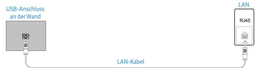
Wenn Sie ein Netzwerk ohne feste IP-Adressen (dynamisches Netzwerk) haben, sollten Sie ein ADSL-Modem oder einen Router, das bzw. der das Dynamic Host Configuration Protocol (DHCP) unterstützt, verwenden. Modems und Router, die DHCP unterstützen, stellen automatisch die Werte für IP-Adresse, Teilnetzmaske, Gateway und DNS zur Verfügung, die das Gerät benötigt, um auf das Internet zuzugreifen. Sie müssen sie dann nicht manuell eingeben. Die meisten Heimnetzwerke sind dynamische Netzwerke.
