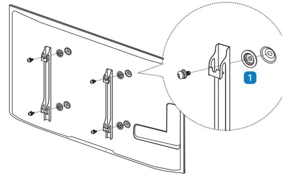
Verwenden Sie den Haltering (1), wenn Sie die Wandhalterung eines anderen Herstellers einbauen.
