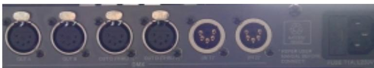
**ACHTUNG:** Wenn der Ausgang C oder D auf OUT eingestellt sind, dürfen die zugehörigen IN - Buchsen nicht belegt werden, d.h. ist die Buchse OUT C auf OUT eingestellt (im Menü CONFIG vornehmen), dann darf die Buchse (IN 1) nicht belegt werden - entsprechend OUT D und (IN 2). Die Belegung kann zur Zerstörung der angeschlossenen Geräte oder des NSPs führen!
